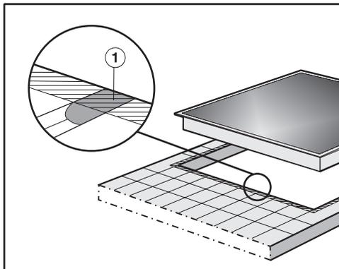
Стыки ① и зашлифованная область под поверхность газовой панели конфорок должны быть гладкими и ровными, чтобы панель лежала ровно и уплотнение под кромкой верхней части прибора обеспечивало достаточную герметизацию столешницы.
