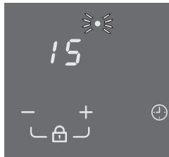
На дисплее погаснет индикатор конфорки, а индикатор соответствия таймера конфорке будет мигать.
